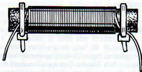
Fig. 7 - Coloro che volessero costruire l'induttanza  $L$ , dovranno far riferimento a questo disegno, che suggerisce il modo di comporre la bobina su uno spezzone di ferrite cilindrica, nella quale i terminali dell'avvolgimento sono bloccati con fascette stringifilo di plastica.
