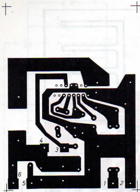
Fig. 5 - Disegno in grandezza naturale del circuito stampato, che l'operatore dovrà comporre su una delle due facce di una basetta supporto delle dimensioni di 7 cm x 10 cm.
